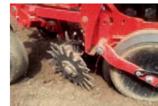
▲ Sterwielen Sterwielen op de zaaimachine halen de gewasresten uit de rij zodat die het zaaien niet bemoeilijken.
