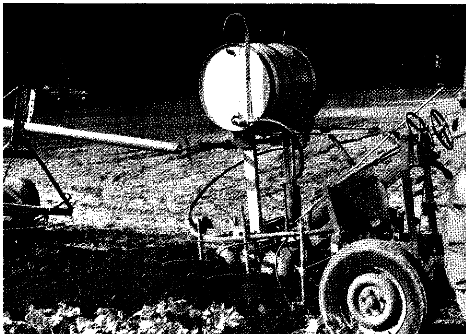
Fig. 108. Ploeginjecteur met vlottersysteem. Het vat kan ook op de trekker zijn geplaatst.
