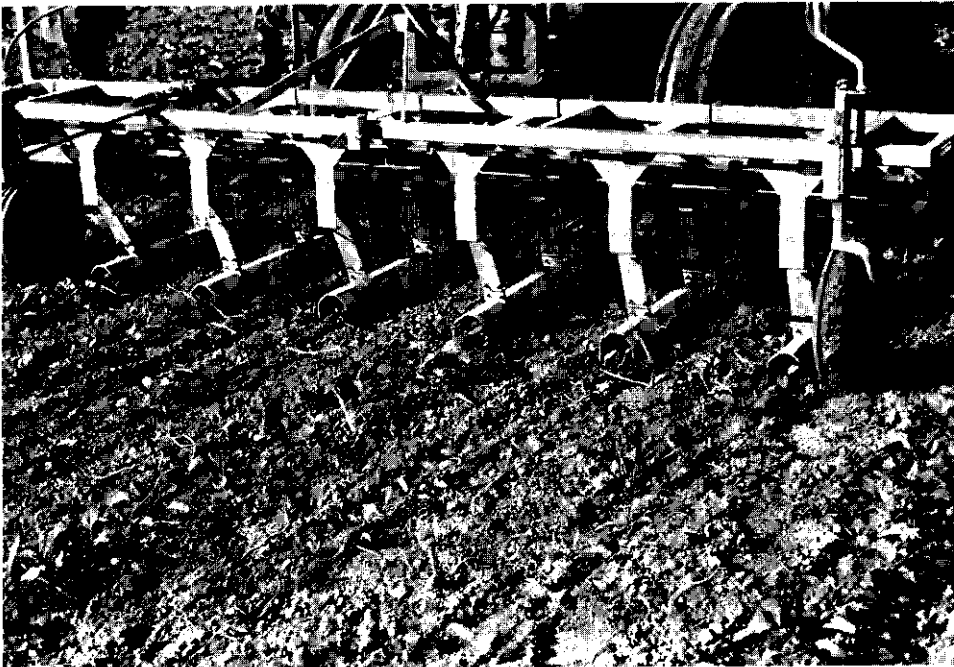
Fig. 99. Bij een strokendruppelaar wordt het gewas bij het passeren van het werktuig in de kappen gevouwen en zo tegen raken door het onkruidbestrijdingsmiddel beschermd.
