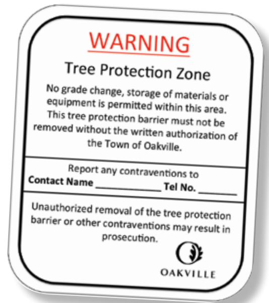
Afbeelding 3 Voorbeeld van bebording van boombeschermingszone bij werkzaamheden in Oakville.
