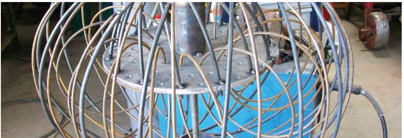
Kluit uit stalen staven voor een kunstmatige 'proefboom'
