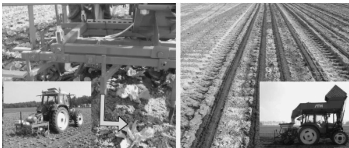
Figuur 4. Curatieve onkruidbestrijding Sarl Radis intrarijwieder in de gewasrij (links). Preventieve onkruidbestrijding in de gewasrij door onkruidvrije zaaistroken (rechts).
