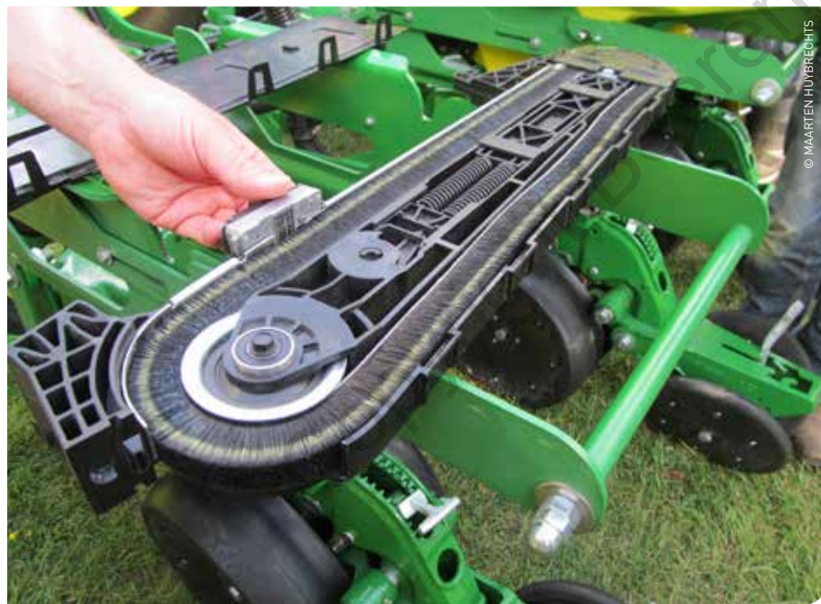
Op SIMA 2015 kreeg John Deere een medaille voor de precisiezaaimachines met elektrische aandrijving en borstelevator. Dit resulteert in hoger rijsnelheden en dus een grotere capaciteit.
