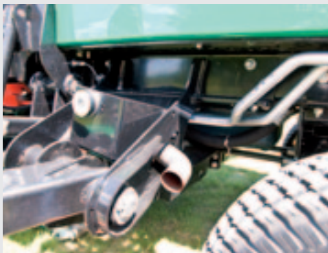
De draagarm van de buitenste maaikooi, gemonteerd aan de H-balk van de MP5.
