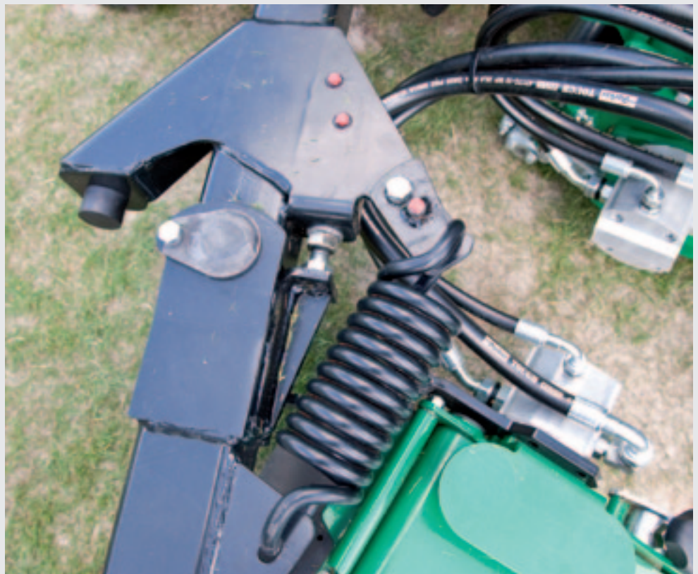
Een veer zorgt dat de buitenste kooien kunnen uitwijken bij een aanrijding met een obstakel. Die veer is bevestigd met het rode breekboutje. De andere twee rode boutjes zijn ter vervanging.
