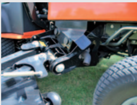
De draagarm van een vleugelmaaidek, gemonteerd aan de H-balk van de MP3.
