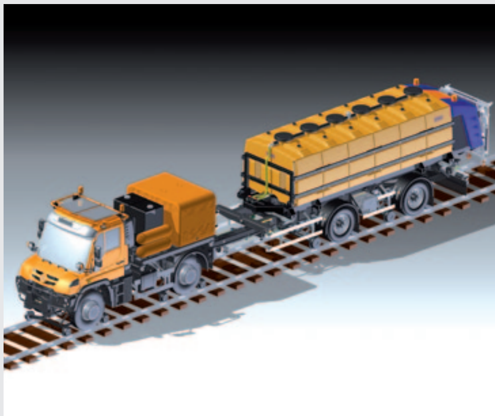
De multifunctionele trailer van Staja, hier in spooruitvoering en voorzien van een waterdrager voor thermische onkruidbestrijding of reinigen van geluidsschermen.
