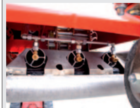
Iedere box heeft drie lpg-injectoren. De ontsteking is elektrisch.
