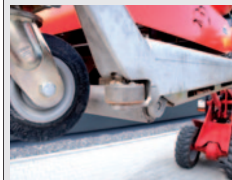
Kleine horizontale loopwielen aan de zijkanten voorkomen schampen langs een muur.
