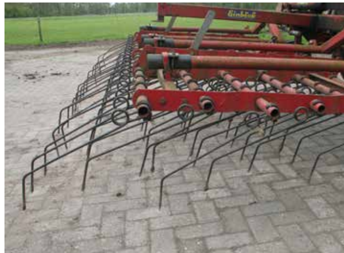
Goed eggen, met name in een jong stadium is vooral een kwestie van een goede afstelling van de eg in combinatie met de juiste rijsnelheid
