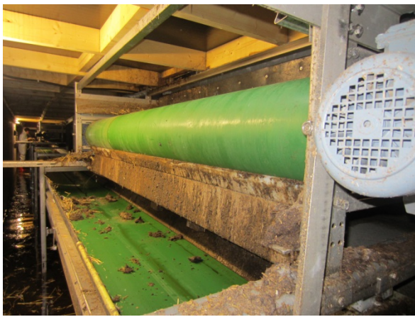
Mestband onder de roosters van de Star+ stal.
