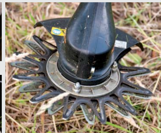
Het bovenmes heeft een tand meer dan het ondermes. Daardoor verspringen ze ten opzichte van elkaar en ontstaat er een gelijkmatige belasting. De boutjes pakken nog wel eens slappe planten.
