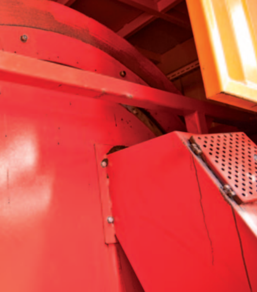
De trommel heeft stilstaande zijvlakken. Daardoor kan continu droge fractie worden toegevoegd en compost worden afgestort.
