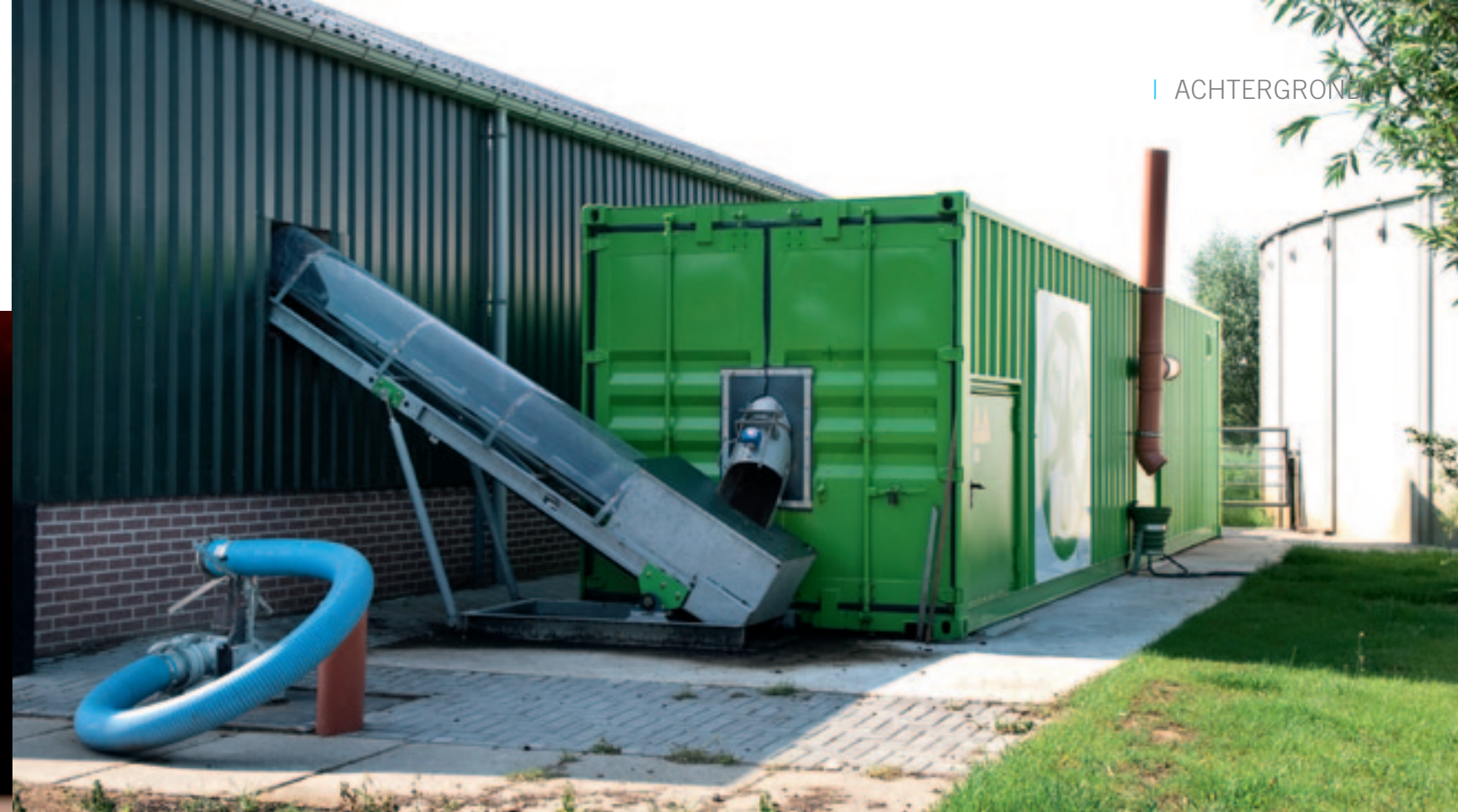
Deze Bauer Bedding Unit staat buiten opgesteld, ook de mestscheider staat in de container. De compost wordt opgeslagen in twee bunkers in de naastliggende veldschuur. De dunne fractie wordt afgepompt naar de mestsilo of een van de mestkeldercompartimenten.
