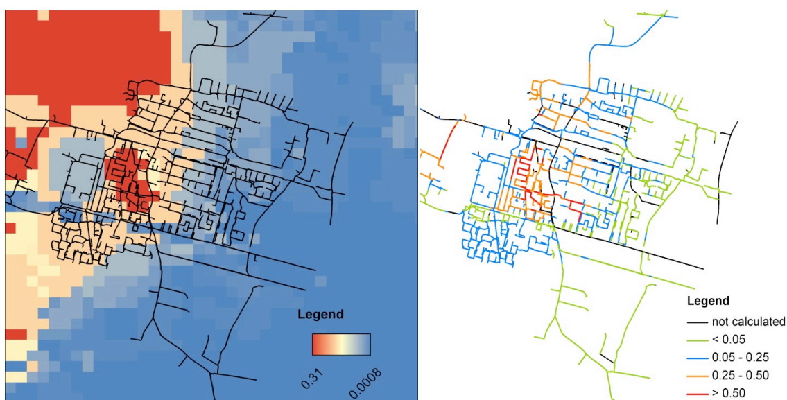
Afbeelding 3. Voorbeeldberekening van COMSIMA (= COMputation Stresses In MAins)
