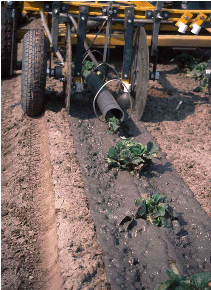
Aanleg van bodemafdekkende materialen in de aardbei.
