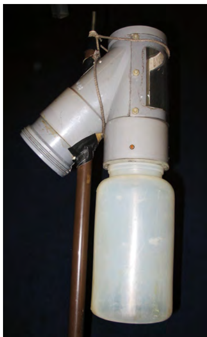
8. Large grey 75 mm PVC collector for Malaise traps with 1 l bottle. Photo: C. van Achterberg 8. Grote grijs 75 mm PVC verzamelpot voor Malaisevallen met 1 l plastic pot.
