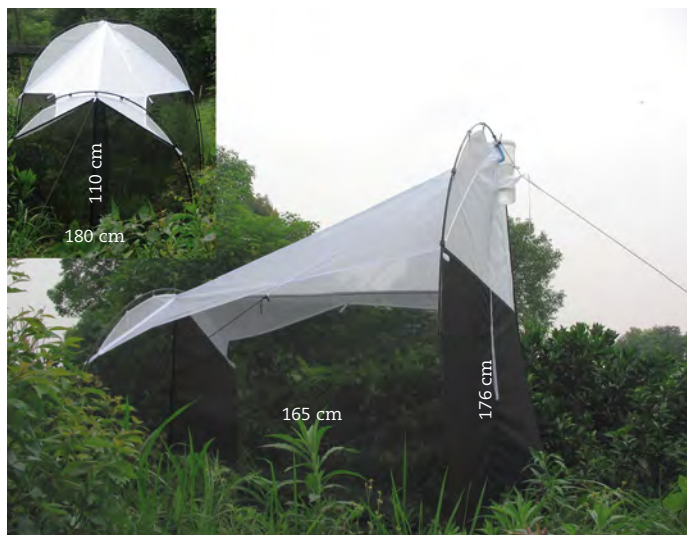
12. Bugdorm design of Malaise trap with rounded roof and no rods. Photo: C. van Achterberg 12. Bugdorm ontwerp van Malaiseval met rond dak en zonder stokken.
