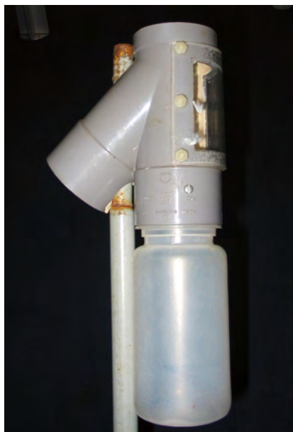
9. Small grey 50 mm PVC collector for Malaise traps with 0.2 l bottle. Photo: C. van Achterberg 9. Kleine grijs 75 mm PVC verzamelpot voor Malaisevallen met 0.2 l plastic pot.
