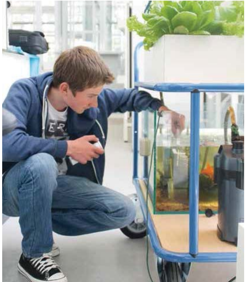
Vmbo-leerlingen Thijs Jager laat bij een aquaponics-unit zien hoe je met een indicatorstrookje de waterkwaliteit kunt meten
