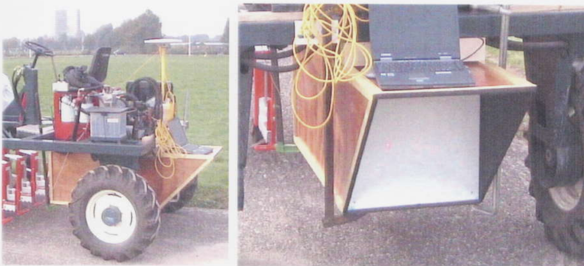
Figuur 4 De bevestiging van de laserbox aan AutoMaatje. In de rechtse figuur is de spot van de LASER op de acrylaat plaat waar te nemen.
