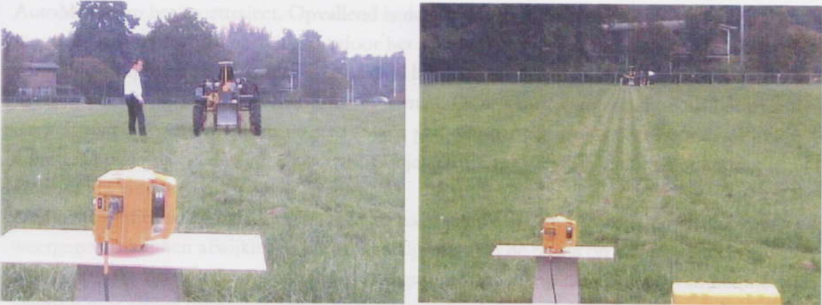
Figuur 5 De meting op gras. In de linker figuur bevindt het AutoMaatje zich aan het begin van het meettraject; op de rechter figuur is de meting voltooid.
