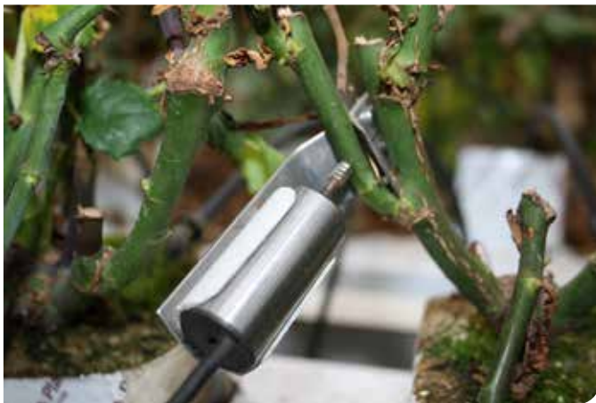
▲ Op basis van bijvoorbeeld stengeldiameter kan de ontwikkeling van de plant worden opgevolgd. In het IWT-project Sense-IT gaan we met deze en andere sensoren aan het werk.
