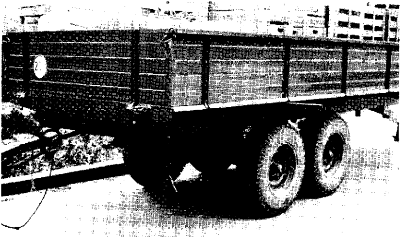
Oogstwagen met aangedreven wielen en aandrijving voor de oogstband
