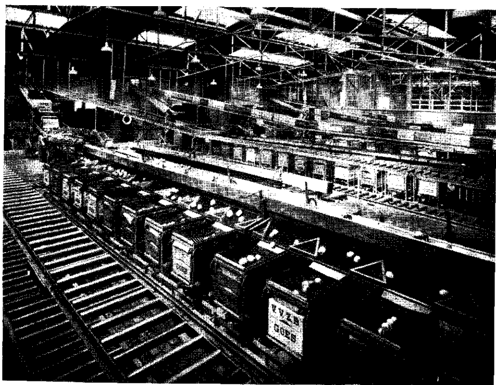
Woebi en Hermes fruitsorteermachines in een centraal pakstation.
