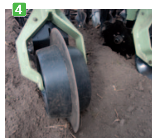
[1] De Orthman is er met brede of smalle rollen. De smalle zijn het meest geschikt voor zandgrond.
