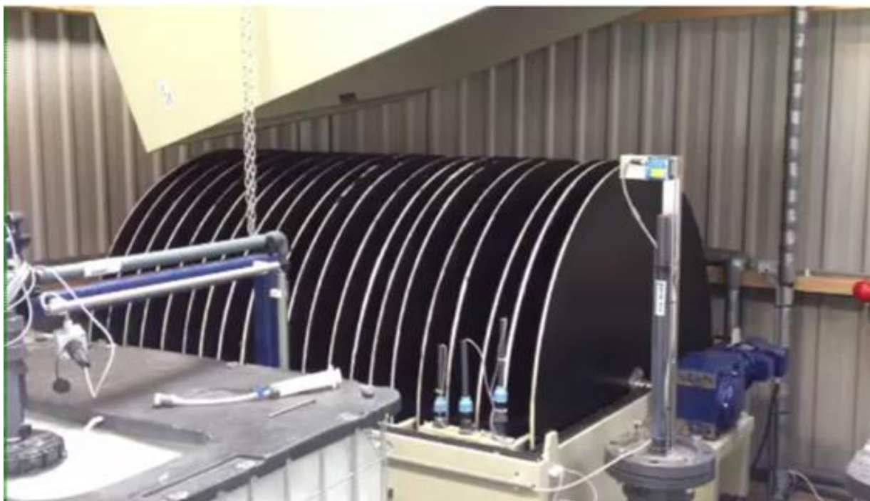
Proefopstelling van de LGL stripper
