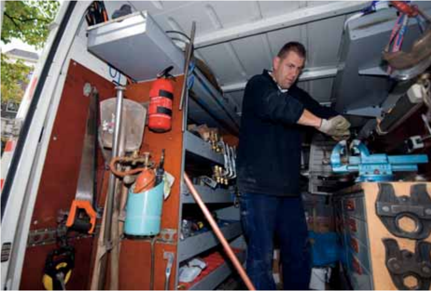
Ter plekke hulpstukken maken om de watermeter te kunnen plaatsen.
