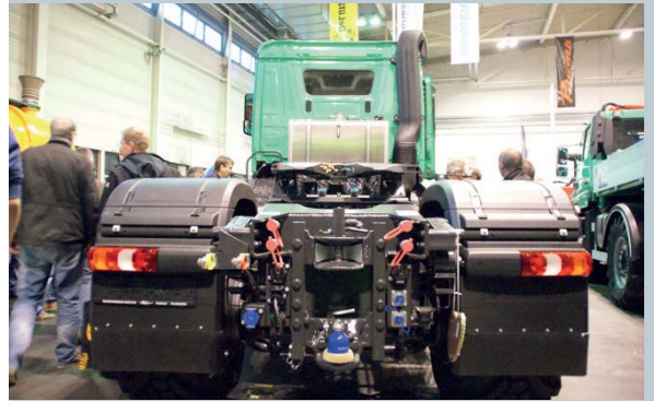
Een schotel met voldoende zijwaartse hellingshoek is toegelaten voor een agrotruck met een maximumsnelheid van 60 km/u. Echt concurrerend met wegvervoer is de truck met deze schotel niet, omdat deze hoger (circa 1,30 meter) zit. Naast deze Paul Agromover op Mercedes-Benz Arocs 4x4-basis ziet Mercedes hernieuwde kansen voor de Unimog Agro.
