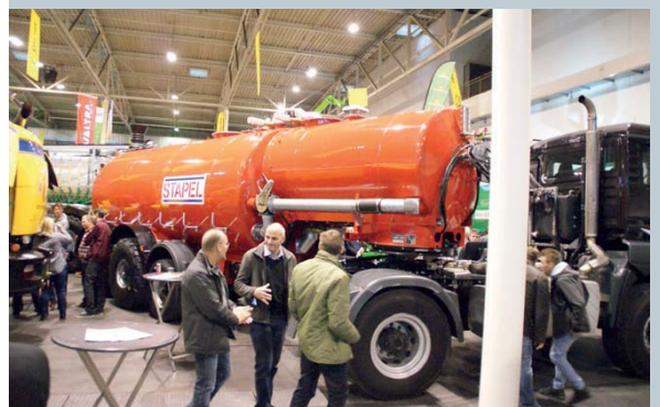
Fabrikant Stapel ontwikkelde deze mestoplegger met apart voorcompartiment om op de staat leeg vier ton oplegdruk op de kogel te creëren en in het veld met liftas desgewenst zeven ton extra.
