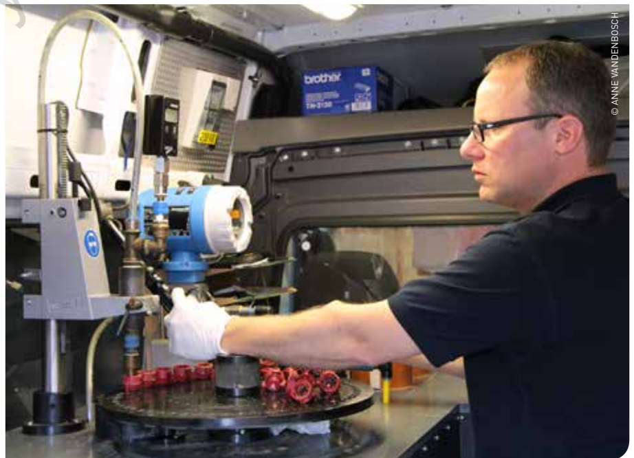
Bij de keuring van spuitmachines worden onder meer de doppen getest. Een te hoog debiet blijft de voornaamste reden voor afkeuring.
