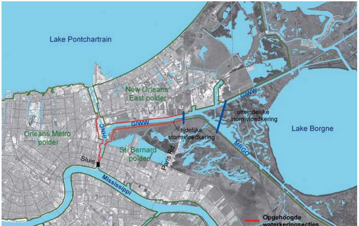
Afb. 1: De drie polders waarin het grootste deel van New Orleans ligt. Tevens de locatie van de tijdelijke stormvloedkering bij het alternatief 'Aanleg tijdelijke stormvloedkering' en van de geplande definitieve stormvloedkering en de opgehoogde waterkeringsecties bij het alternatief 'Optimaal verhogen waterkeringen'.
