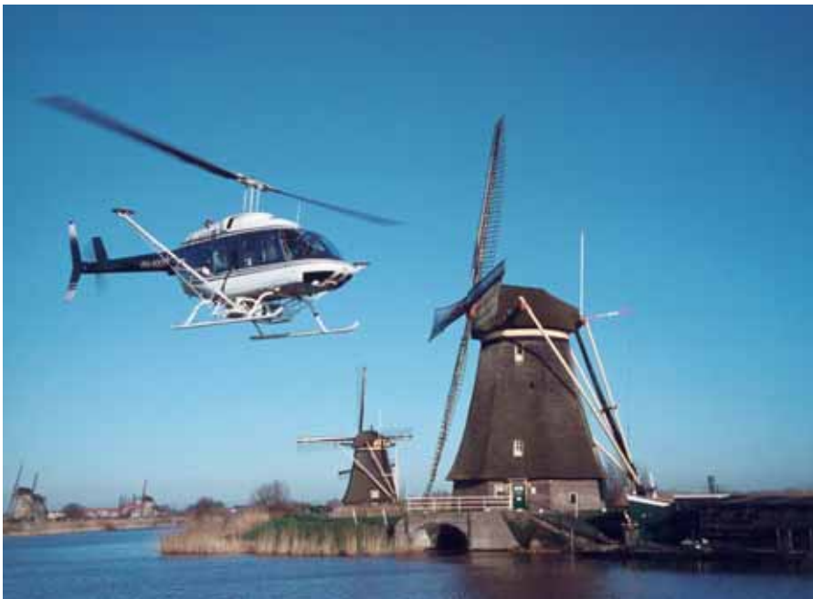
Hoogtemetingen bij Kinderdijk met behulp van het FLI-MAP-systeem (foto: Fugro).
