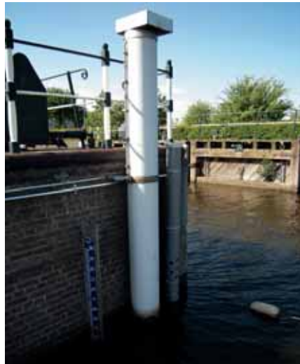
De sonde bij het inlaatpunt van water uit het Volkerak-Zoommeer.
