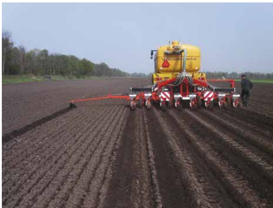
In maïs is het mogelijk 30 procent te besparen op de stikstofgift door dierlijke of kunstmest in de rij toe te passen. Vanwege de noodzakelijke nauwkeurigheid en de afname van het areaal dat dagelijks gezaaid kan worden wordt deze techniek voor dierlijke mest nog nauwelijks in de praktijk gebruikt.
