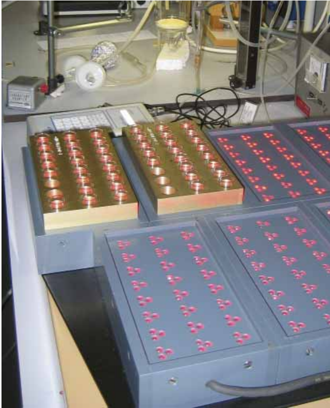
PAM-opstelling voor het meten van fotosynthese-efficiëntie in algen.
