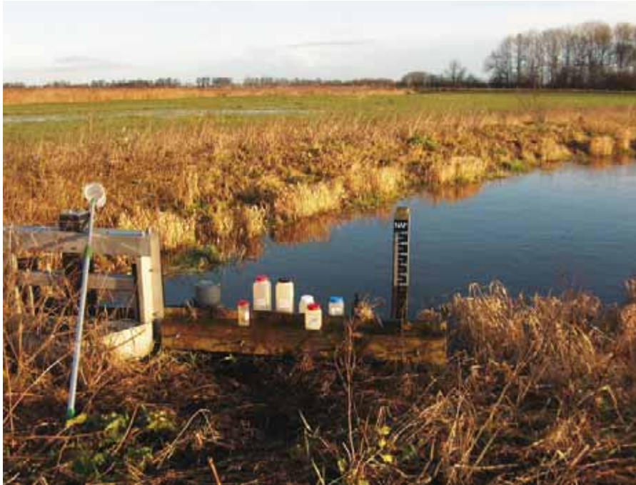
Uitlaat van het het proefgebied met enkele watermonsters die bestemd zijn voor diverse wateranalyses.
