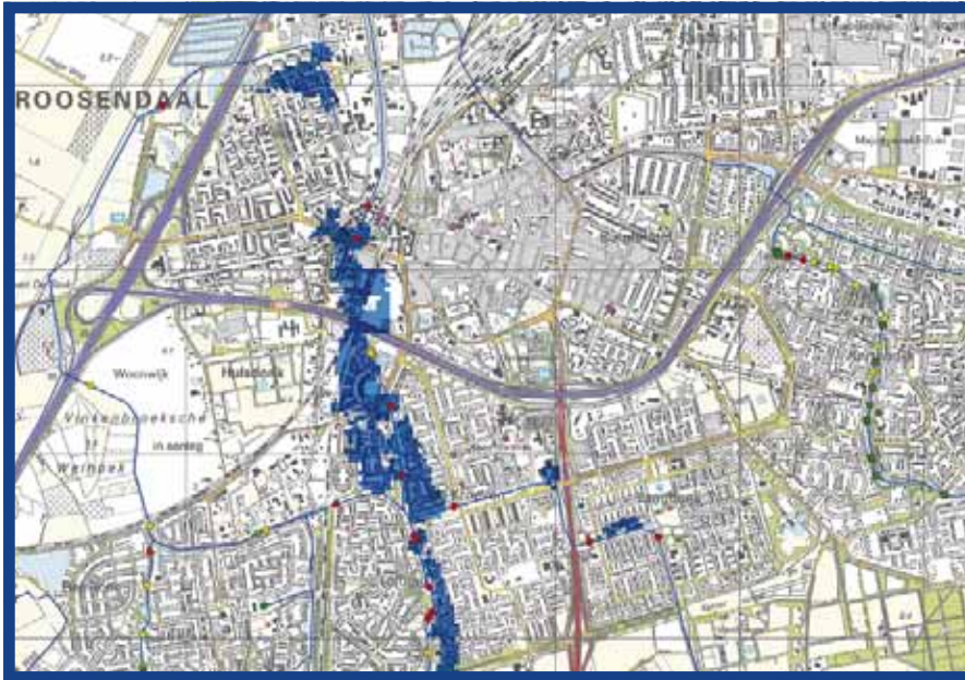
Afb. 3: Berekende inundaties vanuit het oppervlaktewater (T100).
