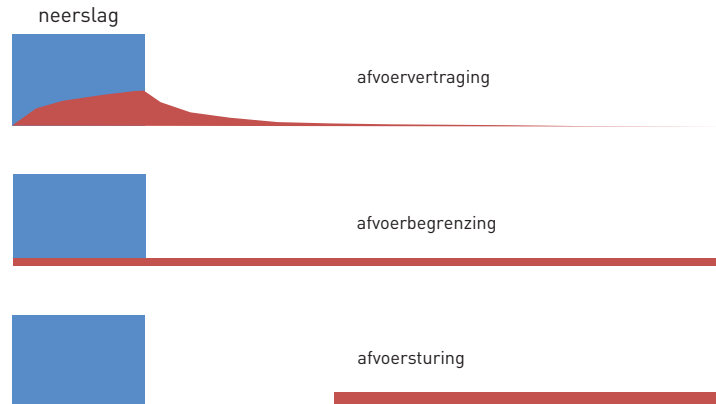
Afbeelding 6 - Karakteristieke verschillen in typen dakafvoer
