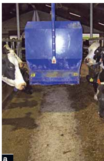
Foto 5 Con i sistemi automatici per l'unifeed (a) la larghezza della corsia di foraggiamento può essere ristretta di circa il 50% rispetto a quanto necessario per il transito di carri miscelatori (b)
