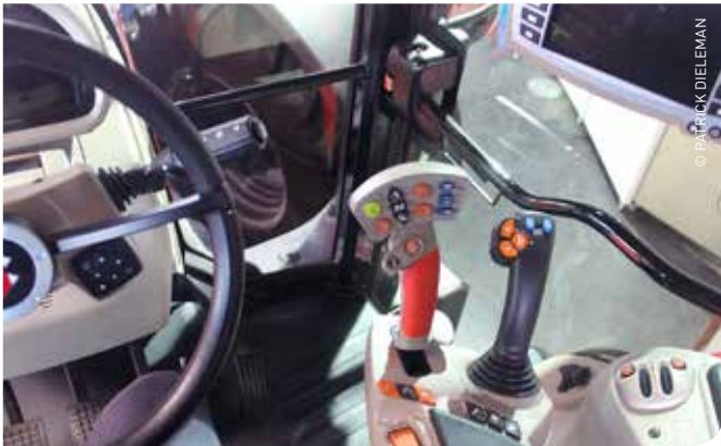
Op de joystick staan knoppen, waaraan men tijdelijk taken kan toewijzen die men op dat moment veel moet uitvoeren.
