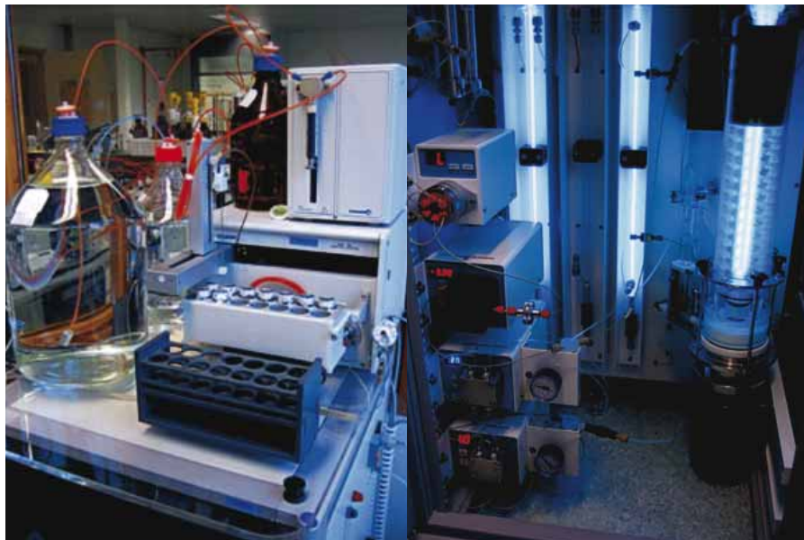
Meetopstelling voor de NOM-analyse. Links bovenaanzicht, rechts binnenaanzicht met aan rechterkant de DOC-detector.
