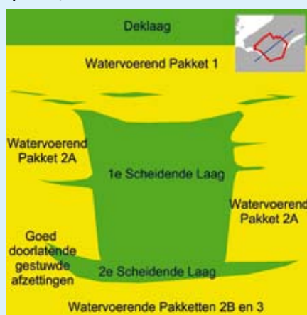
Afb. 3: Geschematiseerd geohydrologisch model (niet op schaal).
