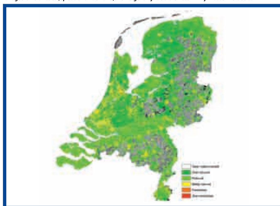
Afb. 8: Robuustheidskaart zoals die gebruikt wordt in de klimaat-effectatlas. De kaart combineert de effectkaart (zoals gegenereerd met HydroS voor een 1/25 bui in het 2050 W-scenario) met een kaart met gevoeligheden van landgebruiksfuncties (op basis van de LGN5). Vervolgens zijn de uitkomsten in vijf klassen verdeeld.
