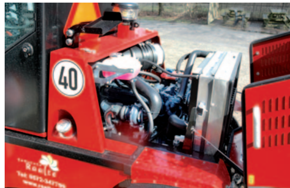
De viercilinder diesel is van VM. Hij heeft een inhoud van drie liter en levert 63 kW (85 pk). De motor-kap gaat snel en makkelijk open. Dat vergemakkelijkt de periodieke service.
