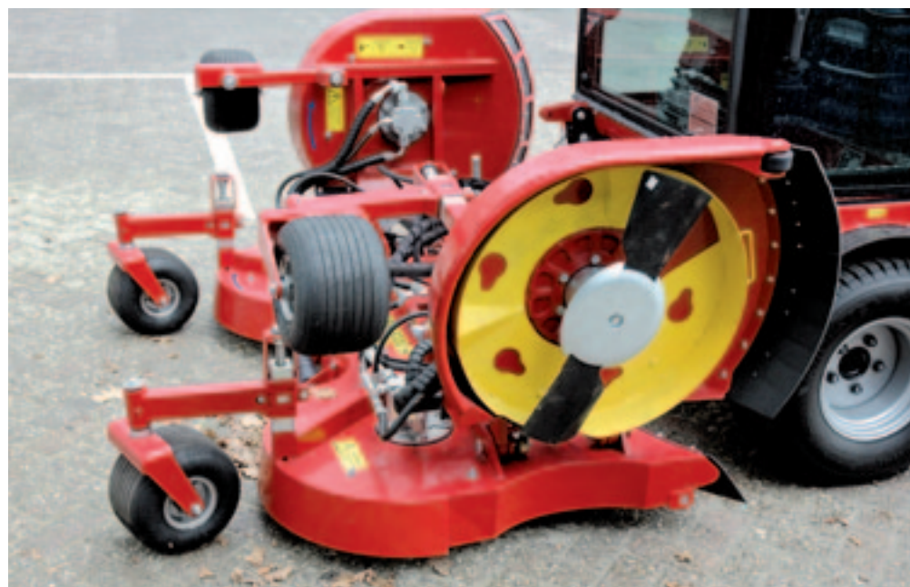
Het maaidek heeft (in het geel) een mulchkit. Het looprolletje in de zijdekken (rechtsboven) voorkomt dat het dek bij het dalen in de grond slaat. Bij oplappen schakelt de mesaandrijving uit.
