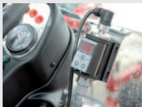
Met dit kastje kan de chauffeur zelf regelen hoeveel gewichtsoverdracht er moet zijn van het maaidek naar de voorwielen.
