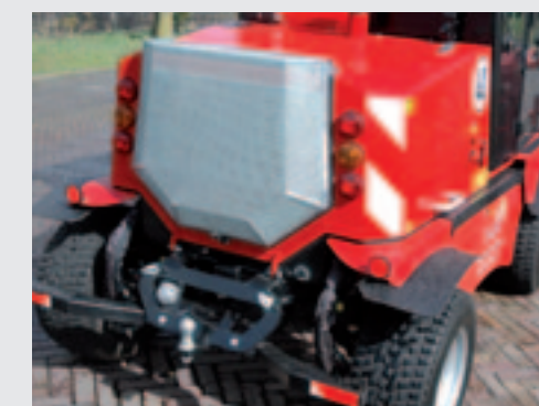
Deze extra kap voor het gas van de radiator vangt het grove vuil op. De kap is op te klappen en makkelijk schoon te maken.
