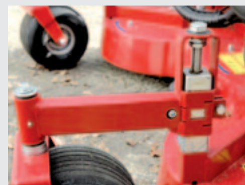
De steunwielen van het dek staan iets slepend, waardoor ze spoorvaster zijn. De maaihogte is traploos instelbaar.
