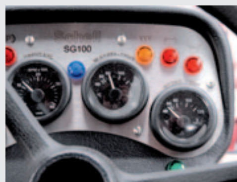
Links de toerenteller van de motor; in het midden de temperatuur van het koelwater en rechts die van de hydrauliekolie.
