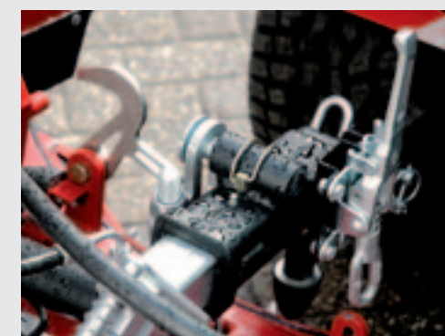
Veiligheidsvoorzieningen zijn op de Schell in ruime mate aanwezig. Hier de mechanische vergrendelingen voor het maaidek.
