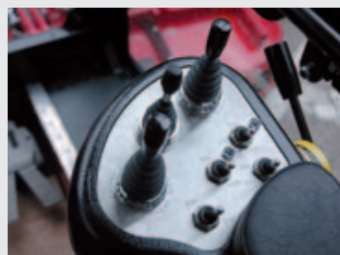
De hendeltjes zijn voor het maaidek; de schakelaartje voor de messen, voor de auto-functie en voor enkel- of dubbelwerkend.
