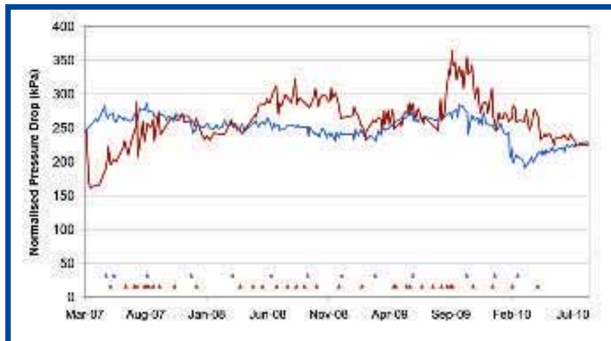
Afb. 1: Genormaliseerde drukval van de RO 1-installatie met PAA-dosering (blauw) en de referentie RO 2 (bruin). Onder het aantal CIP-acties per RO.
