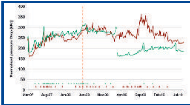
Afb. 3: Genormaliseerde drukval van de RO-installatie met DBNPA-dosering (groen) en de referentie RO (bruin). Onder in de figuur het aantal CIP per RO.
