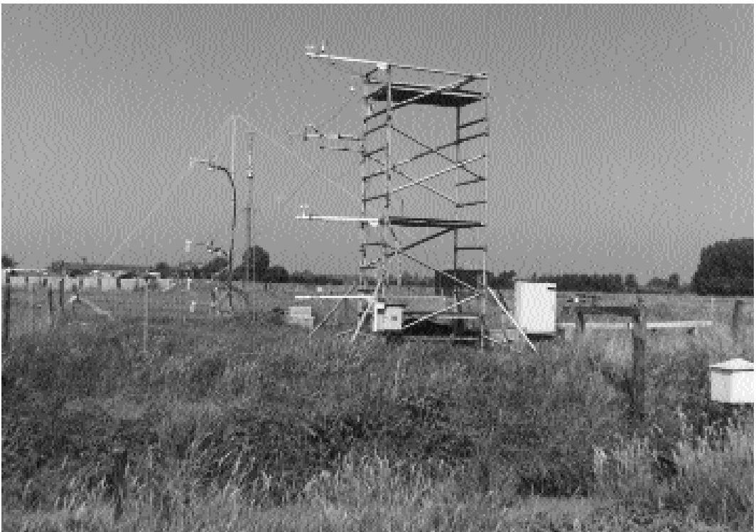
Van een deel van de mineralen weten we niet precies waar ze blijven. Om hier achter te komen is er nog veel onderzoek nodig. Hier een opstelling voor denitrificatie-meting op ROC Zegveld.
