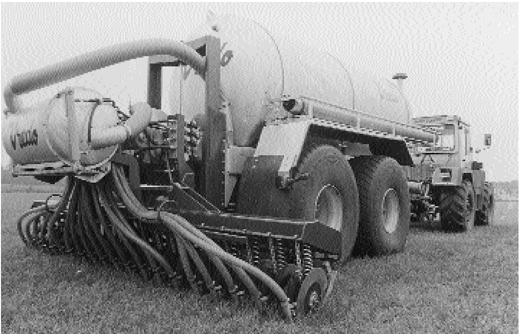
Mest toedienen met een zodebemester geeft een emissiereductie van 83% ten opzichte van bovengronds uitrijden.
