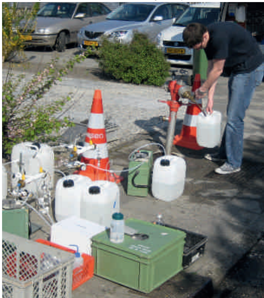
De bemonstering van 120 L drinkwater met een ultrafiltratie unit gebeurde op locatie door Bioclear en Oasen.
