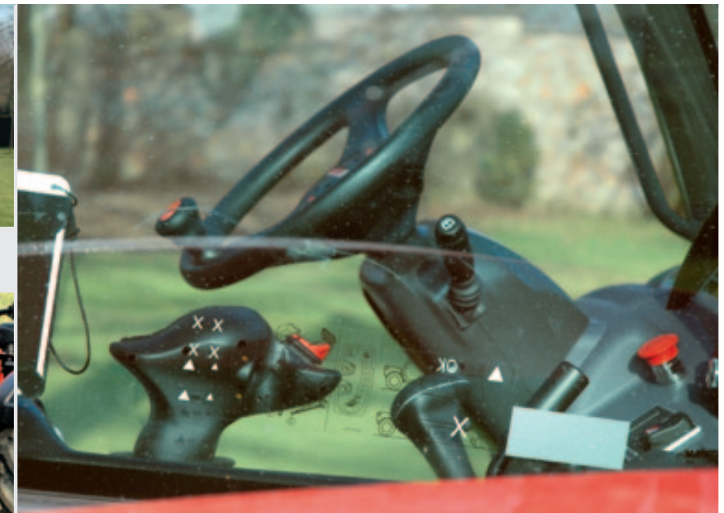
Links de ergonomisch gevormde joystick met in het rood de tuimelschakelaar voor voor- of achteruit. In het midden de pook voor de vier versnellingen. Rechts het pookje voor de drie vormen van besturing.
