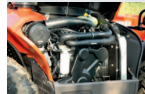
De viercilinder Deutz ligt in de lengte en is dankzij de ver openende motorkap goed toegankelijk.
