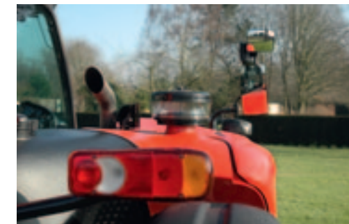
Tussen de normale en de dodehoekspiegel zit de spiegel waarmee je voor de machine kijkt.
