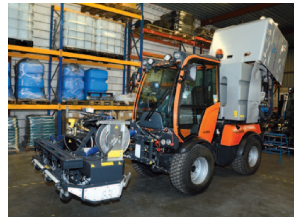
De Wave is een machine die met heet water selectief het onkruid bestrijdt.
