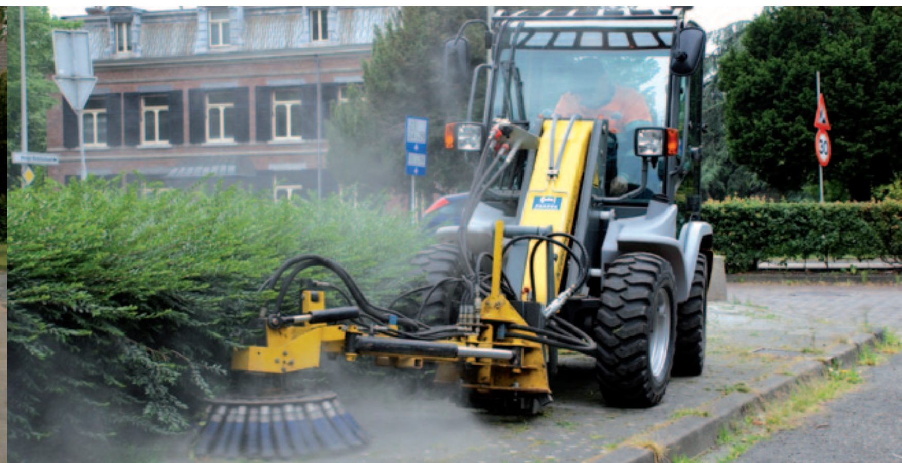
Borstelen is een echt mechanische onkruidbestrijding. Om de slijtage van de borstel en van de bestrating binnen de perken te houden, luistert de afstelling nauw. De borstel aan deze Kramer is afkomstig van de LM-Trac.
