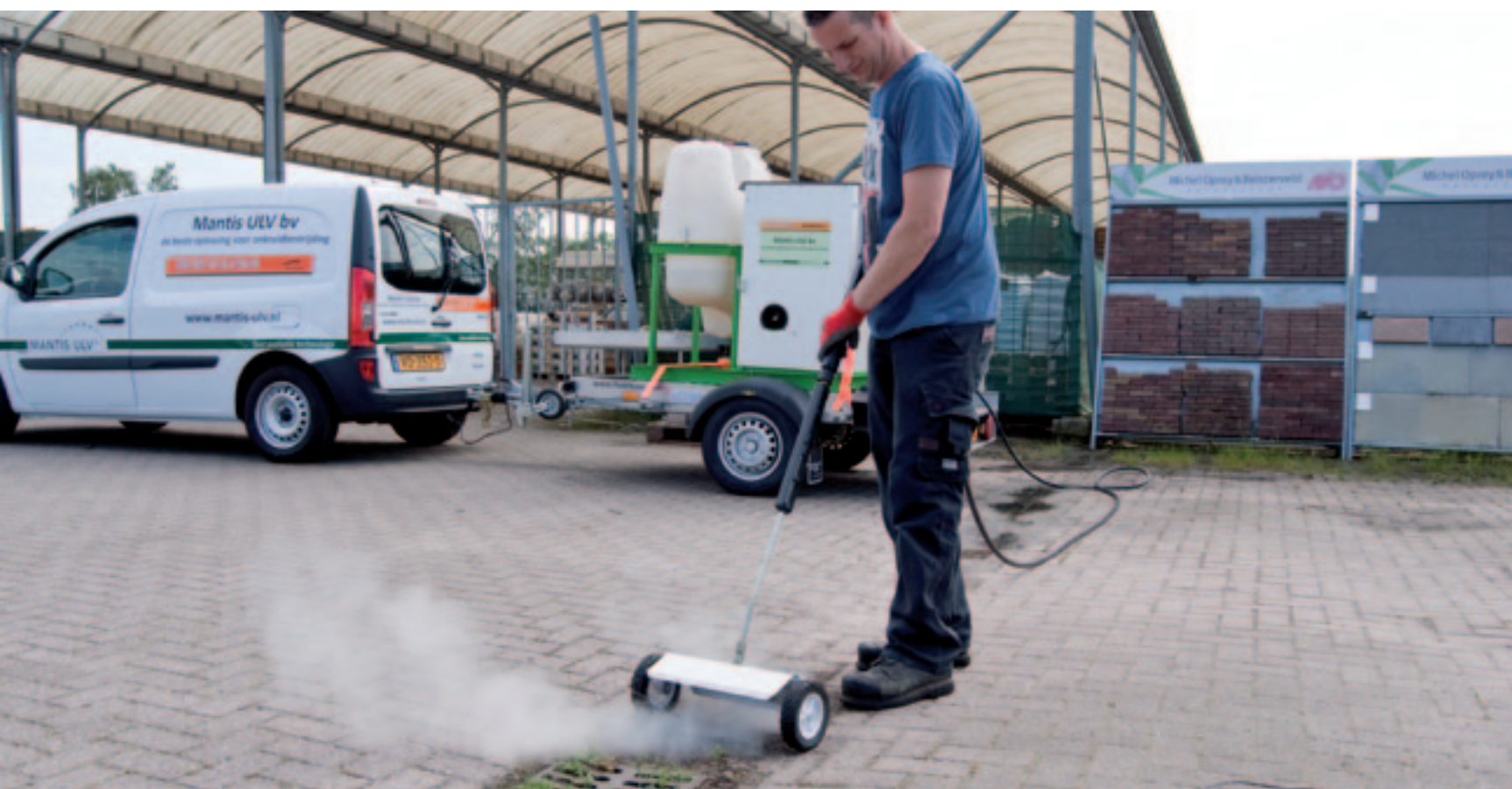
Om met heet water op plekken te komen waar een trekker of werktuigendrager niet kan komen, is een compacte heetwaterunit of een unit met lange slang met handlans een optie.
