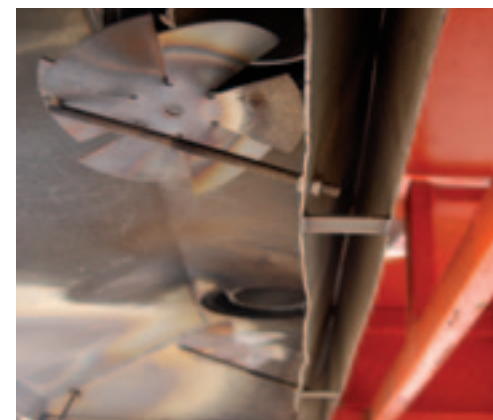
De Zacho Weedblaster voorop een compact-trekker. De Zacho bestrijdt onkruid met hete lucht. Doordat de celwanden barsten, verliest de plant vocht. Bij herhaalde behandeling sterft de plant uiteindelijk af.
