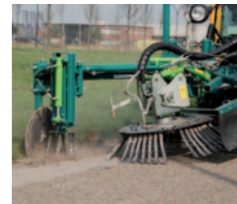
De Ecofour van Weed Control snijdt ook de kanten en werkt dat losse onkruid apart met een kleine borstel weg. De grote borstel neemt het resterende oppervlak voor z'n rekening.
