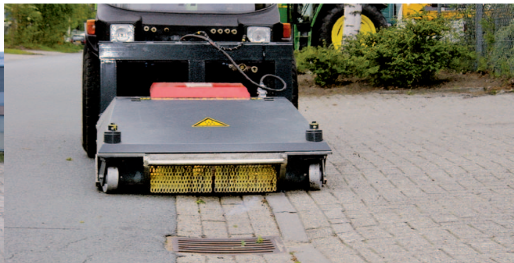
Het onkruid te lijf met een open vlam lijkt een methode die vanwege praktische nadelen afneemt in populariteit en plaatsmaakt voor hete lucht. De praktische gevaren zijn uiteraard de risico's op ontbranding bij het branden langs hagen, opslag of schuttingen.
