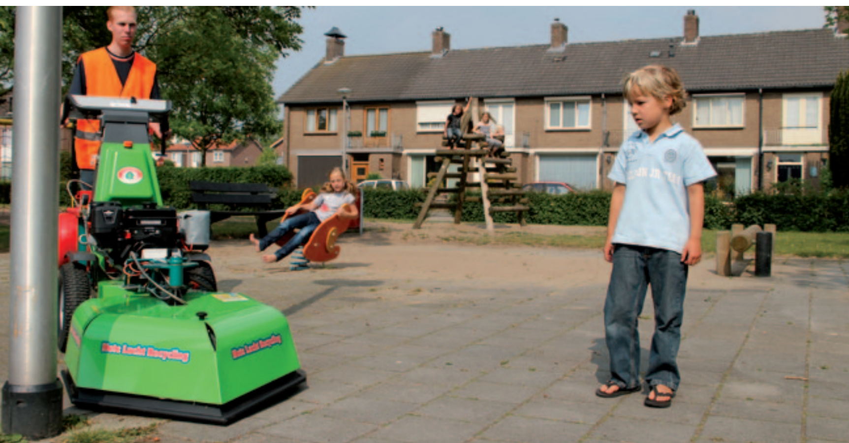
De Ecoflame Combi Compact is een kleine zelfrijder die is in te zetten op lastig te bereiken plekken. Door de 'recycling' van de hete lucht is het gasverbruik volgens de fabrikant relatief laag: zo'n 2,5 kg (5 liter) lpg per uur.
