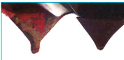
Links een scherpe zaaikouter met de kenmerkende druppel- of Y-vorm. Deze maakt een mooi voortje waar het zaadje klem in komt te liggen. Rechts een versleten zaaikouter. Deze kunt u beter vervangen voor u gaat zaaien.
