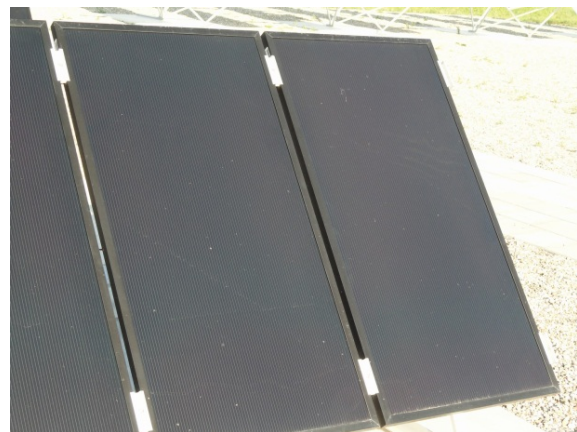
Foto 5: dunne film CIS panelen van Sulfurcell
