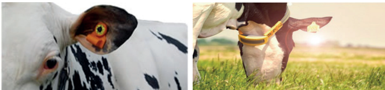
Figuur 3.25 Bewegingssensoren om vreet- en herkauwgedrag van een koe te meten. Links de SensOor van Agis Automatisering BV en rechts de Smarttag Neck van Nedap Livestock Management.
