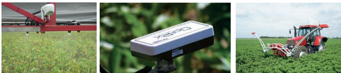
Figuur 3.13 Niet daglicht afhankelijke sensoren van GreenSeeker, OptRx en Fritzmaier.
