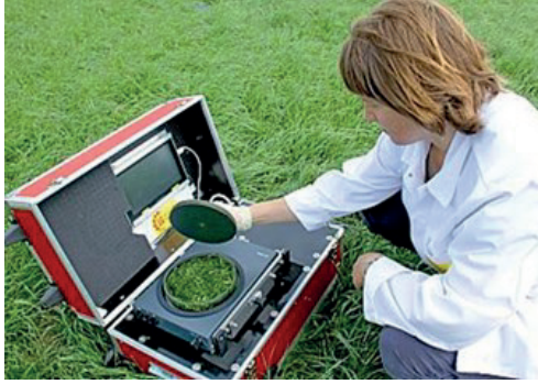
Figuur 3.22 Toepassing NIRS voor meten van inhoudstoffen.
