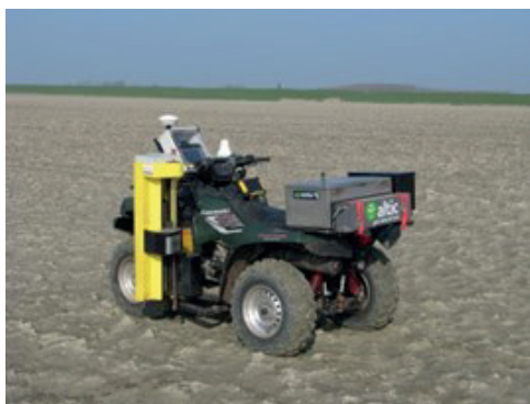
Figuur 3.5 Gamma sensor achterop een quad gemonteerd.
