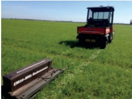
Figuur 3.4 Toepassing van de Dualem bodemsensor op beteelde grond.
