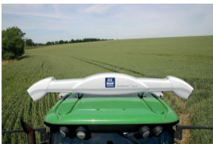
Figuur 3.15 ALS N_Sensor dat de N-status van een gewas meet.
