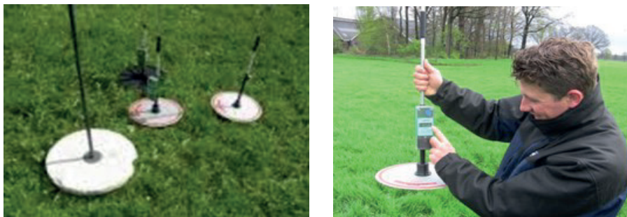
Figuur 3.16 Verschillende uitvoeringen van grashoogtemeters voor handmatig gebruik.
