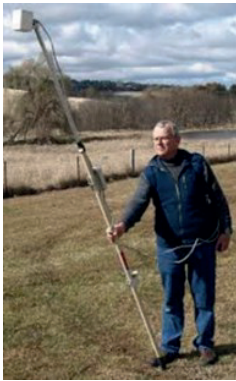
Figuur 3.14 CropScan sensor, handheld systeem om puntmetingen van biomassa te doen.
