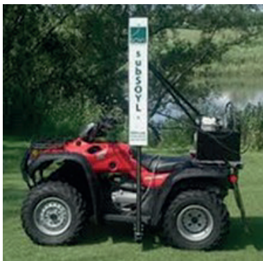
Figuur 3.8 Penetrologger gemonteerd op de zijkant van een quad.
