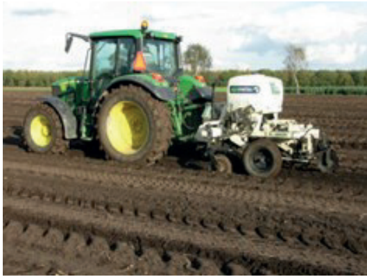
Figuur 3.3 Toepassing Veris MSP3 voor het meten van geleidbaarheid, zuurgraad en organisch stofgehalte.
