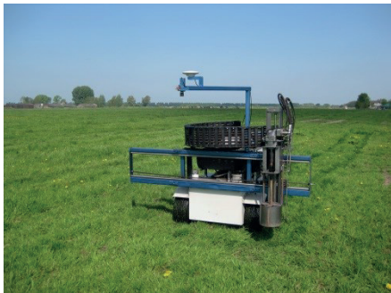
Figuur 3.21 Prototype voor het detecteren en mechanisch bestrijden van ridderzuring ( Rumex obtusifolius L) in grasland (Van Evert et al. , 2011).
