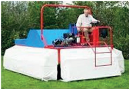
Figuur 3.19 Toepassing hyper-spectrale camera met de Inspector, ontwikkeld door WageningenUR (Schut et al. , 2006).
