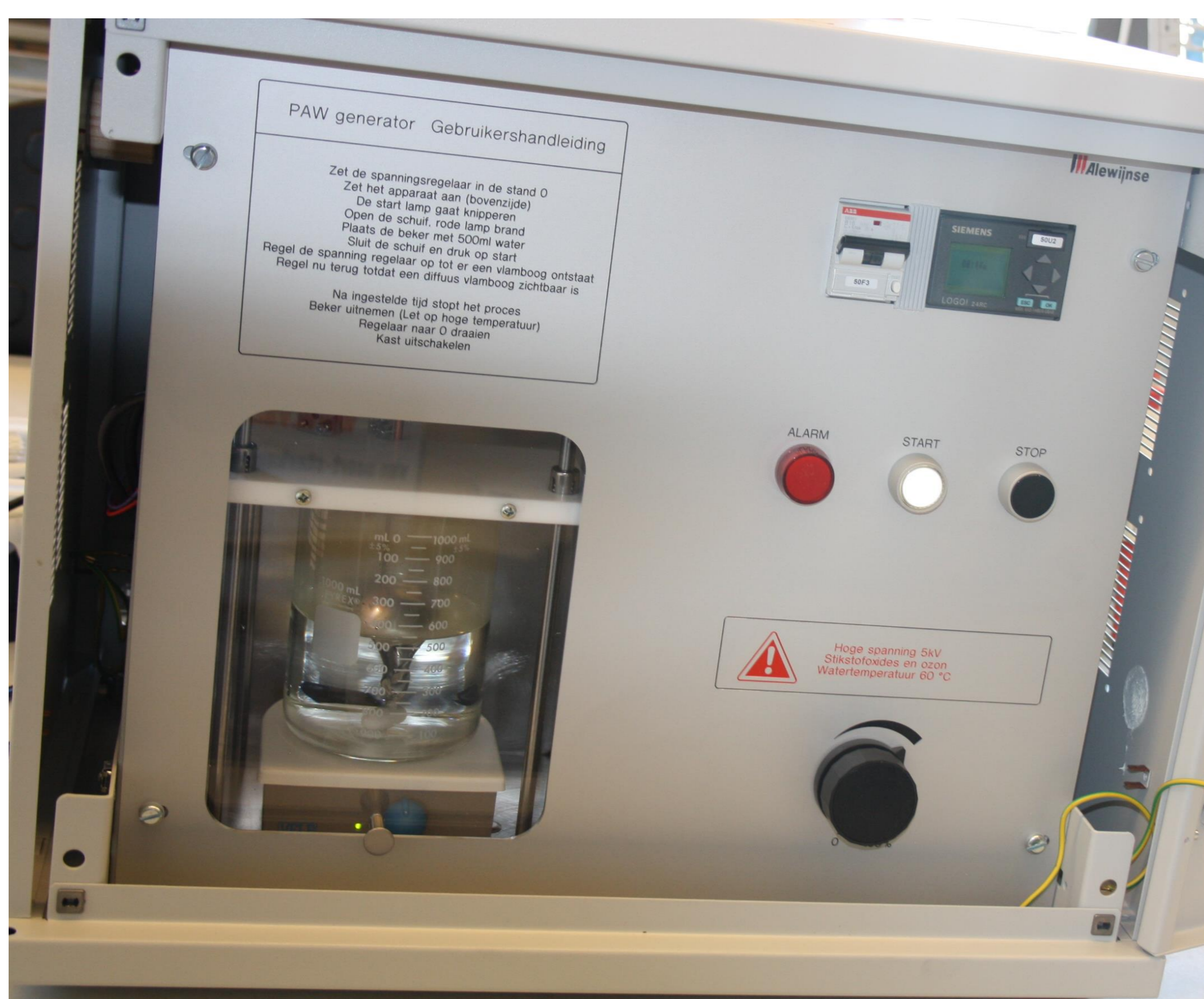
Figuur 1. Stand-alone PAW apparaat voor productie van kleine hoeveelheden PAW. In bekersglas is de bliksemboog te zien.
